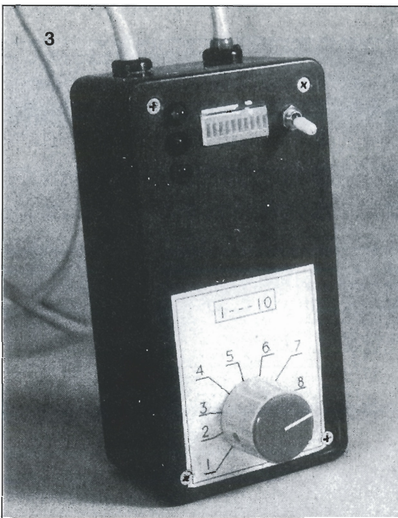
Figura 3. Vemos aquí el prototipo del comprobador de cables. Todos los componentes, a excepción de los conectores Cinch, van montados sobre el circuito impreso.
